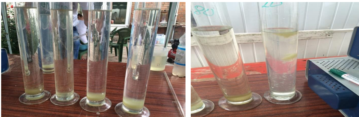
Рисунок 5.6 - Коагуляция с использованием коагулянта Сульфат Алюминия
