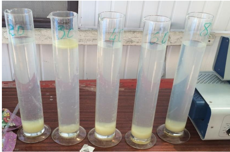
Рисунок 5.18 - Коагуляция с использованием коагулянта СКИФ-180
