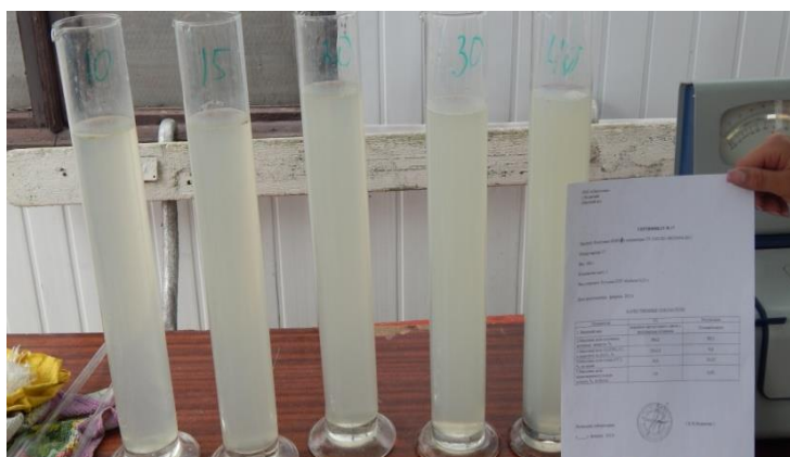
Рисунок 5.22 - Коагуляция с использованием коагулянта КМП-40
