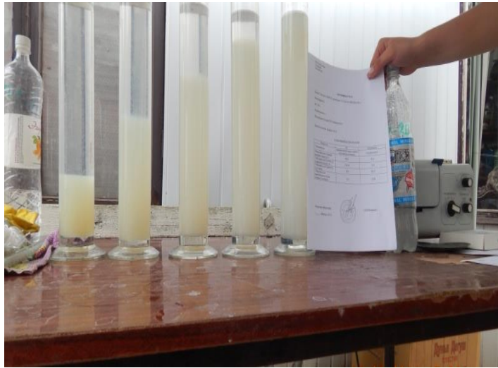
Рисунок 5.20 - Коагуляция с использованием коагулянта КМП-20
