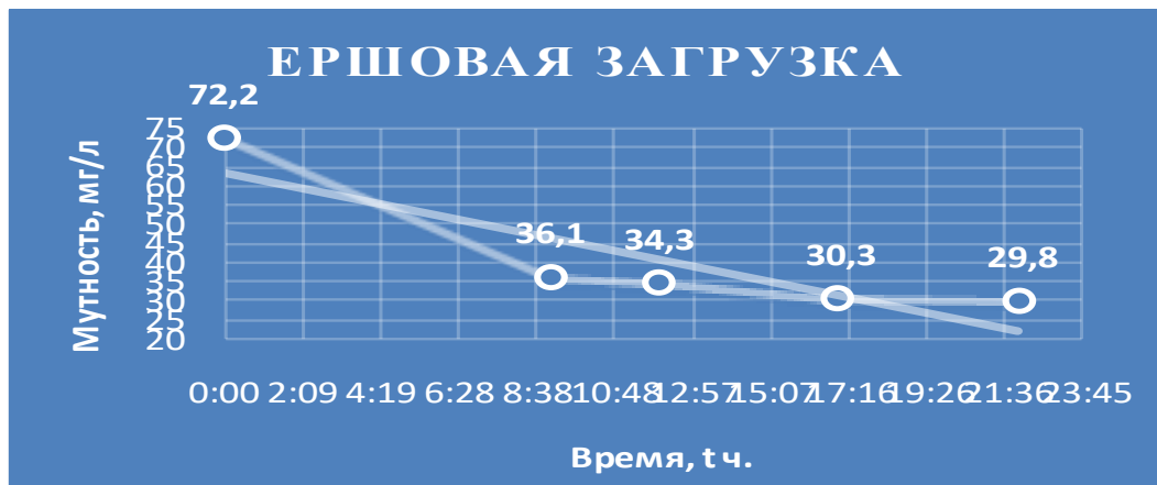
Рисунок 5.41 – Зависимость мутности воды от времени фильтрования воды с сине-зелёными водорослями через лавсановые ерши
