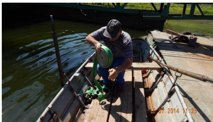
Рисунок 2.3 – Гидрометрические измерения глубин и скоростей чаши водозаборного ковша
