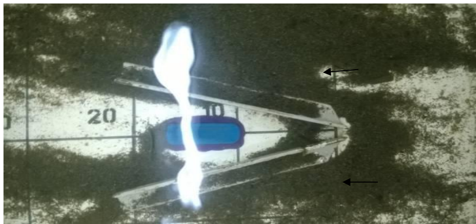
Рисунок 4.15 - Модель с водоприёмным оголовком с рекомендуемым положением порогов
