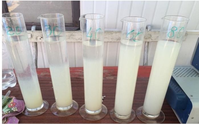
Рисунок 5.16 - Коагуляция с использованием коагулянта КМП-10
